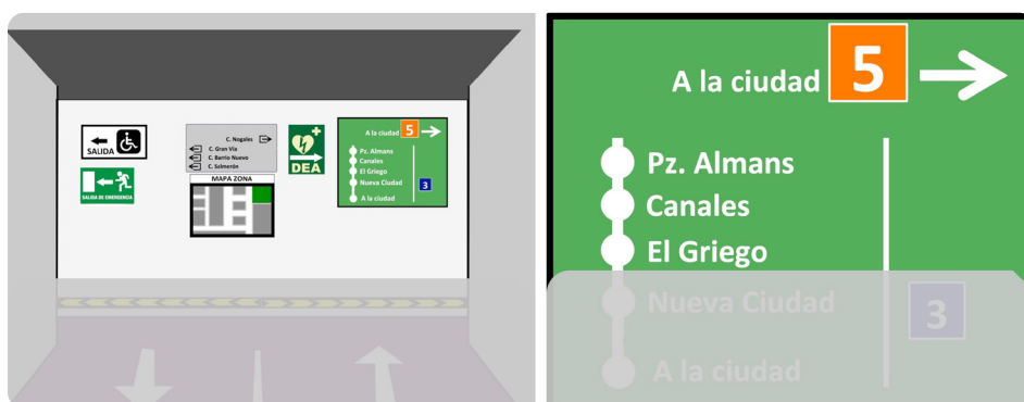
Detalle del pasillo y del panel con pérdida inferior de la visión. Fuente: elaboración de autor.
